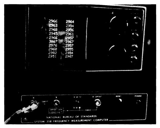
FIGURE 7.5. THE NBS PROTOTYPE, SYSTEM 358 FREQUENCY MEASUREMENT COMPUTER.
